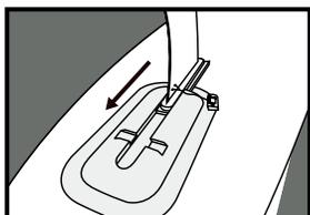
3-4 Installer l'aileron central et les ailerons latéraux
